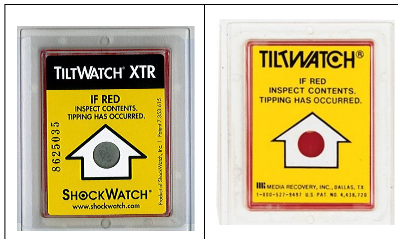
Рис. 3. Индикатор TiltWatch: слева в первоначальном состоянии и справа, если произошло опрокидывание
